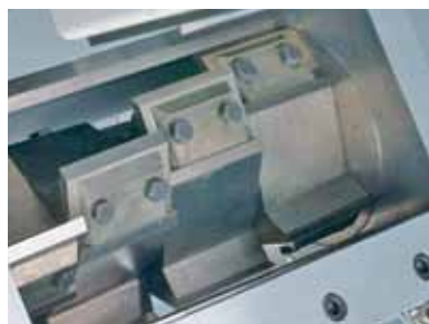
(a) Versetzte Schneidmesser garantieren einen glatten und sauberen Schnitt.
